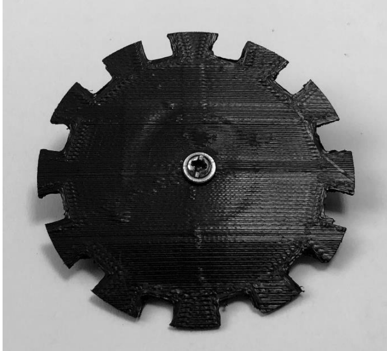
Figura 2: Fotografía del diseño impreso en 3D del disco de obturación contemplando la modificación de la sección externa de obturación y la adhesión de un tornillo para soporte al eje de rotación del motor.
