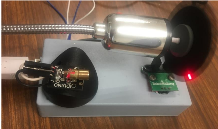
Figura 6: Imagen real del dispositivo recortador de onda en funcionamiento.
