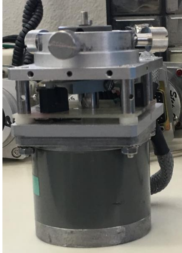
Figura 5 Motores de pasos integrados con sensores ópticos de herradura.
