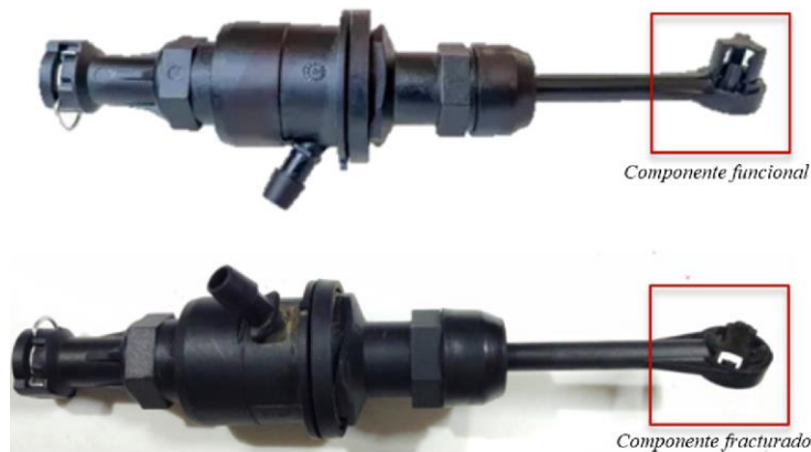
Figura 2. Tipo de falla en la bomba de pedal
