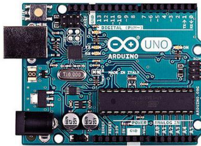
Figura 2. Representa el Arduino UNO.
