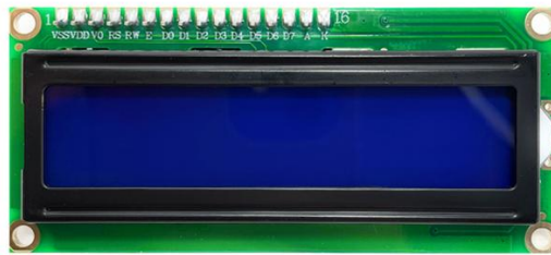
Figura 6. Representa una pantalla LCD.
