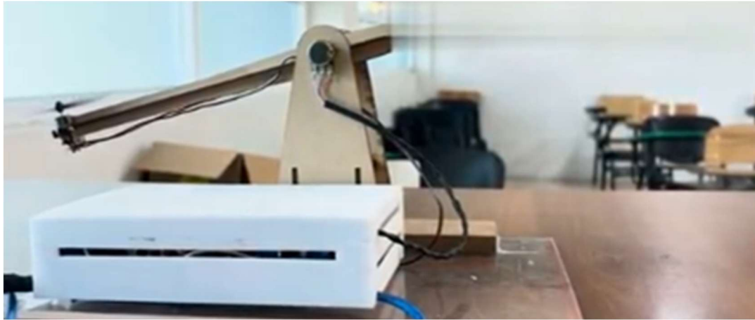
Figura 8. Prototipo físico de helicóptero balancín
