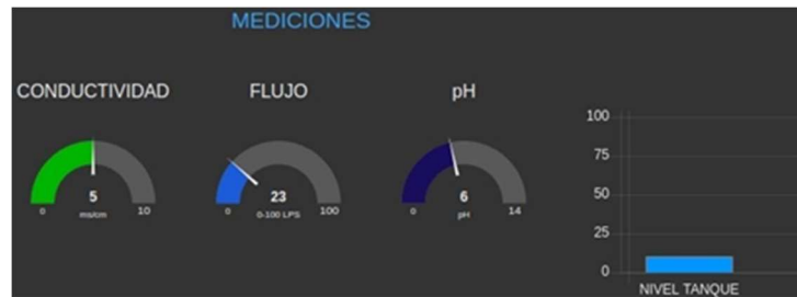
Figura 11. Dashboard local de mediciones del sistema de riego.
