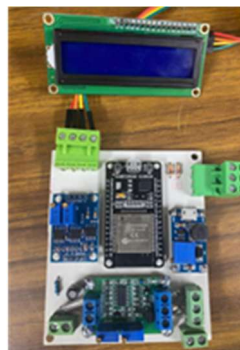
Figura 15. Transmisor de Nivel.
